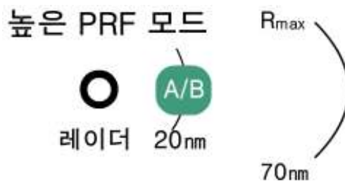
[그림 1.48] 높은 PRF 자료가 수집되기 전에 계산된 높은 PRF 모드에서 계산된 겹보기 거리, 에코 A와 B가 중첩됨에 주의
