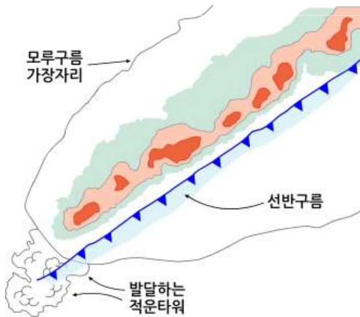
[그림 1.176] 좁은 스콜라인의 반사도 구조 모식도
