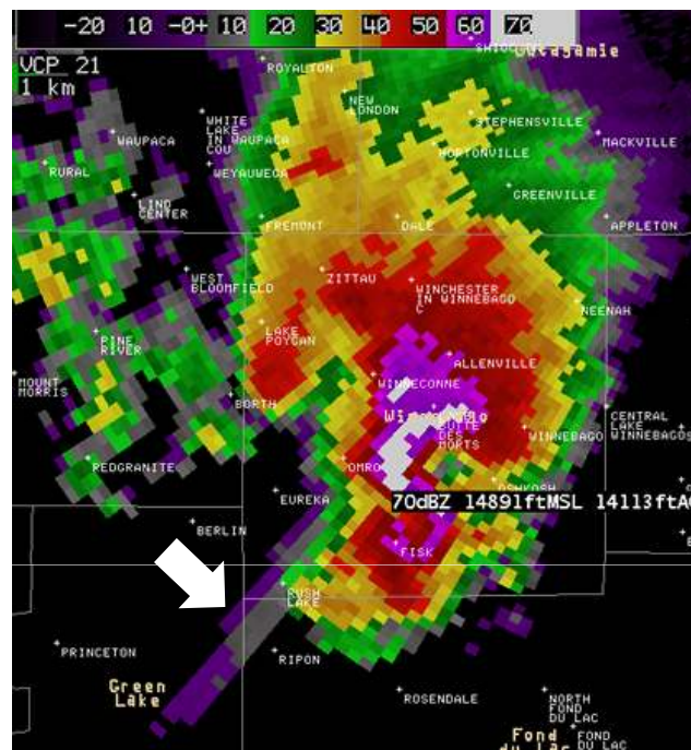
[그림 1.172] 고도각 2.4°에서 관측한 삼체산란 스파이크의 예시
