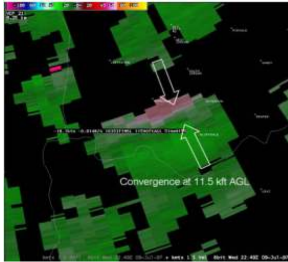
[그림 1.116] 건조 마이크로버스트가 발생하였을 때 1.5도 고도각에서 관측한 시선속도 PPI(1997년 7월 9일 2249UTC). 수렴이 존재하는 지역에서의 레이더 빔의 고도는 약 15kft임
