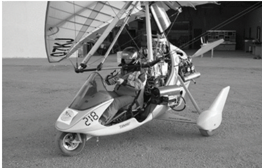
[ 그림 2 ] 프랑스 기후환경과학연구소(LSCE) 초경량 항공기를 이용한 에어로솔 관측 시스템 전경
