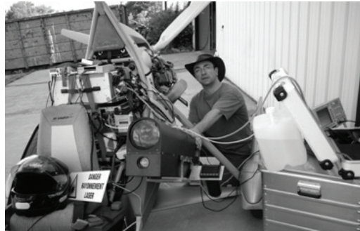
[ 그림 2 ] 프랑스 기후환경과학연구소(LSCE) 초경량 항공기를 이용한 에어로솔 관측 시스템 전경
