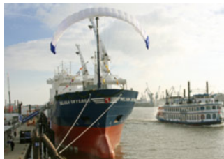
[ 풍력에너지를 이용한 화물선의 대체동력원 "SkySails" ]
