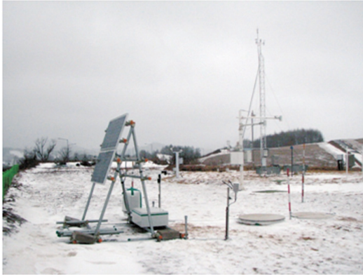
[그림 6] Lee type 중량식 적설계 관측 모습 (대관령 기상대)
