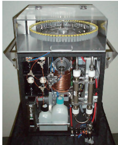
[그림 4] 미국 BMI사에서 제작한 PILS 시스템. 항공기에 탑재되어 에어러솔에 포함된 수용성 이온의 농도를 1분 간격으로 측정할 수 있도록 설계되었다( http://www.brechtel.com/ ).
