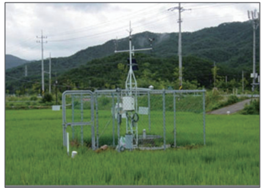
[그림 1] 농업자동기상관측장비의 설치 장면
