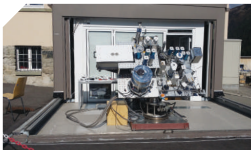
세계복사센터의 세계표준그룹(World Standard Group) 기준기 17대의 비교관측 사진
