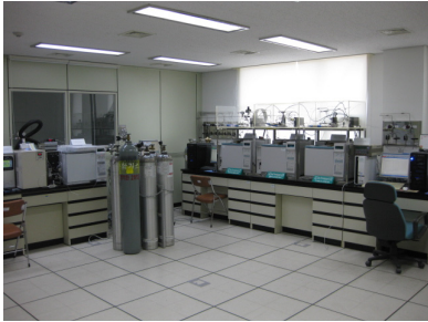
[그림 3-16] 온실가스 감시 장비(왼쪽), 플라스크 분석 장비(가운데), 표준가스 검정 장비(오른쪽)
