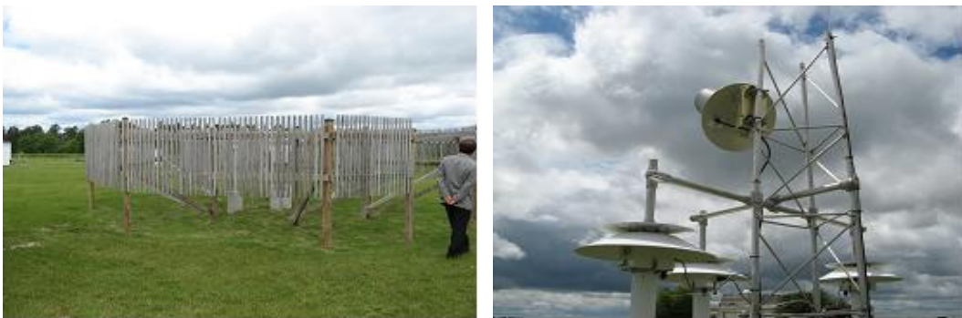
[그림 2-4] 캐나다 표준관측소에 설치된 미국의 DFIR(이중펜스)와 현업 적설센서
