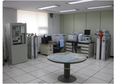
[그림 3-16] 온실가스 감시 장비(왼쪽), 플라스크 분석 장비(가운데), 표준가스 검정 장비(오른쪽)
