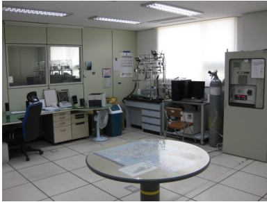
[그림 3-16] 온실가스 감시 장비(왼쪽), 플라스크 분석 장비(가운데), 표준가스 검정 장비(오른쪽)
