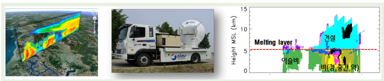
[그림 3-76] 구글기반 자료 표출시스템(왼쪽), 연구용 X-band 이중편파레이더(가운데) 및 하계 집중관측 대기수상체 분류결과(오른쪽)
