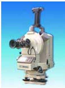
활주로가시거리(RVR) 측정 장비
