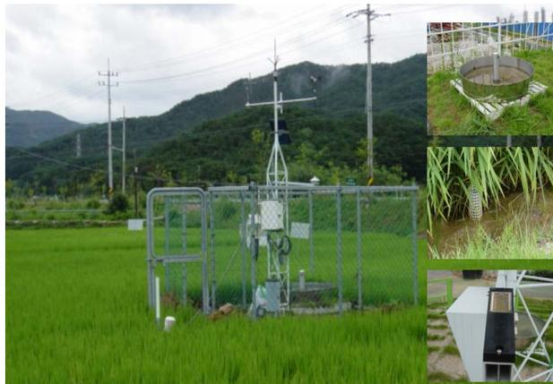
벼 논에 설치된 농업기상관측시스템 (좌) 증발계, 수온계, 결로시간센서(우 위로부터)
