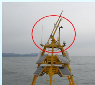
선박충돌로 파손된 중량중속 센서
