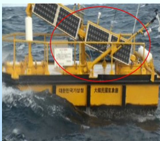
선박충돌로 파손된 관측장비
