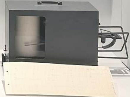
바이메탈자기온도계 바이메탈 자기온도계는 1890년대 후반에 개발된 것으로, 지중온도를 측정하는 데 사용된다. 이 장치는 바이메탈을 사용하여 온도 변화를 측정한다. 바이메탈은 두 가지 다른 금속의 합금으로, 온도에 따라 휘어진다. 이 휘어짐은 기계적으로 기록 펜을 움직여 기록 용지에 기록된다.
