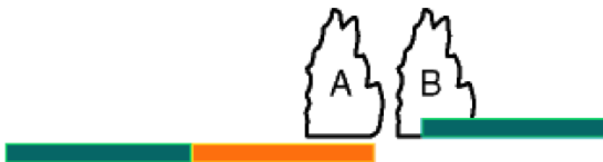
[그림 3.20] 이 그림은 관측 가능한 최대 거리 분해능의 예임. 두 물체는 적어도 펄스 길이의 1/2일 때 분리되어질 수 있음. 위쪽의 녹색 막대기는 송신펄스, 아래쪽의 녹색과 오렌지색 막대기는 목표물 A와 B에 의한 수신신호
