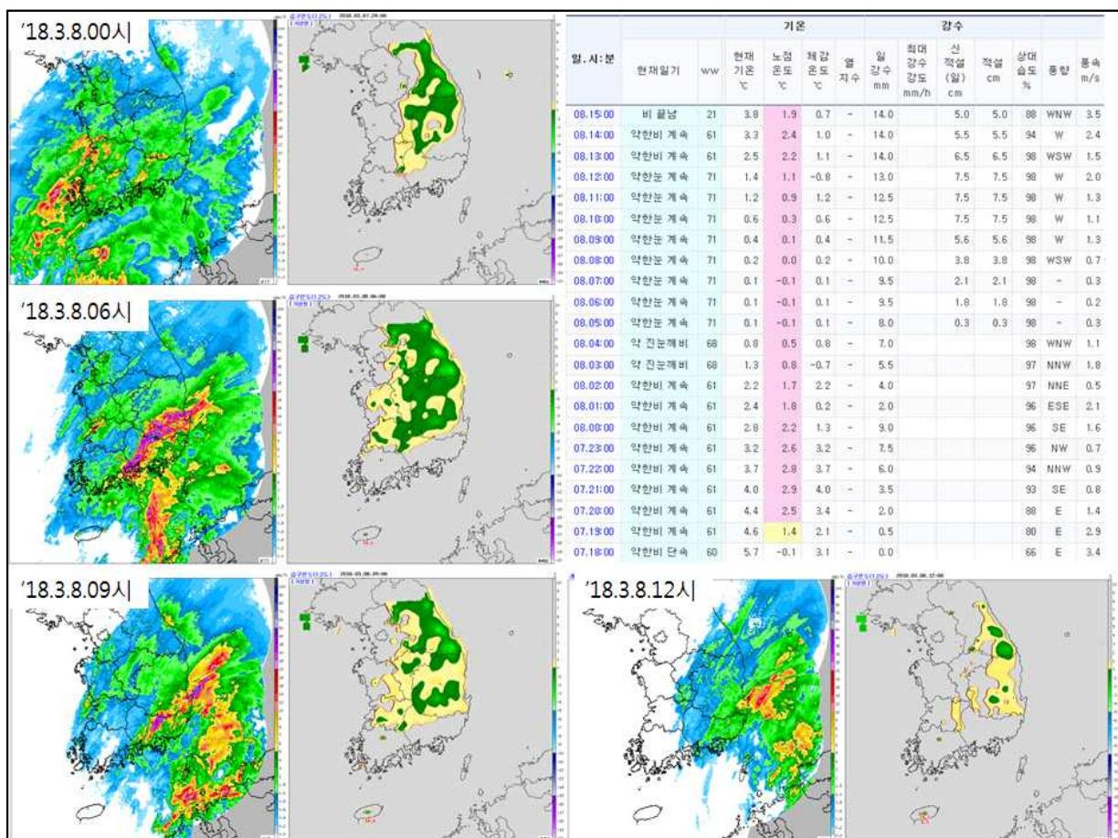
그림 6-9. 2018년 3월 8일 대구지역 레이더 영상과 습구온도 분포( $1.2^{\circ}\text{C}$  이하 채색) 및 매 시각 관측 결과
