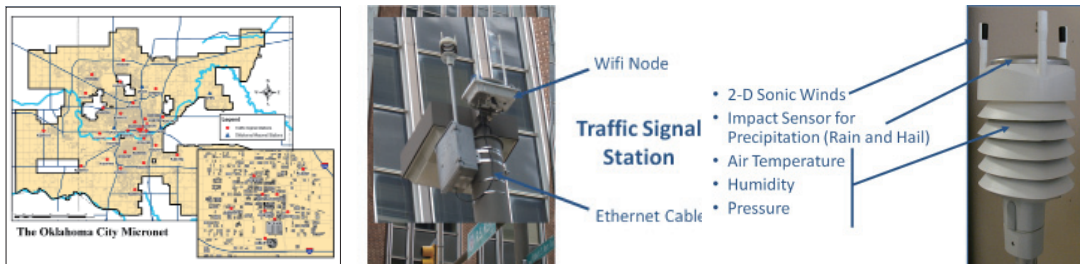
[그림 2] 오클라호마 Micronet 네트워크 구성도(좌)와 관측 장비 설치 현황(우)
