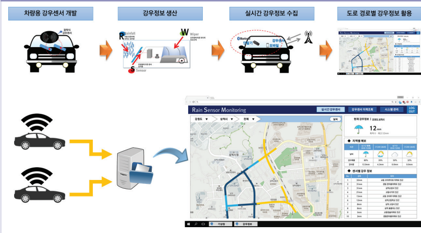
[그림 12] 실시간 강우모니터링 시스템
