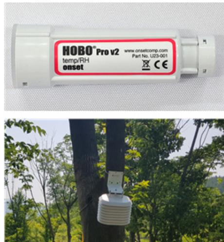
식물은 주변 환경과 다른 국소지역 -암석의 그늘진 곳 같은 특별한 기후나- 지표면으로부터 지상 수 미터 사이(보통 1.5미터)의 기후인 미기후에 많은 영향을 받게 된다. 국립백두대간 수목원의 식물 생육모니터링 시스템에서는 이러한 미기후 환경 데이터를 수집한다. 수집되는 미기후 환경 정보는 토양/대기 온-습도, 토양 EC(전기전도도) 및 CO<sub>2</sub>, CO, O<sub>3</sub>, 광량, 기압, 수온, 미세먼지, 풍향/풍속 등이다. 센서가 부착된 미기후 수집 함체는 상시전원 연결 없이 태양광충전과 충전식 배터리로 운용이 가
