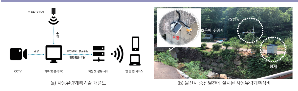
[그림 3] 자동유량계측기술 개념도 및 중선필천 설치 사례도
