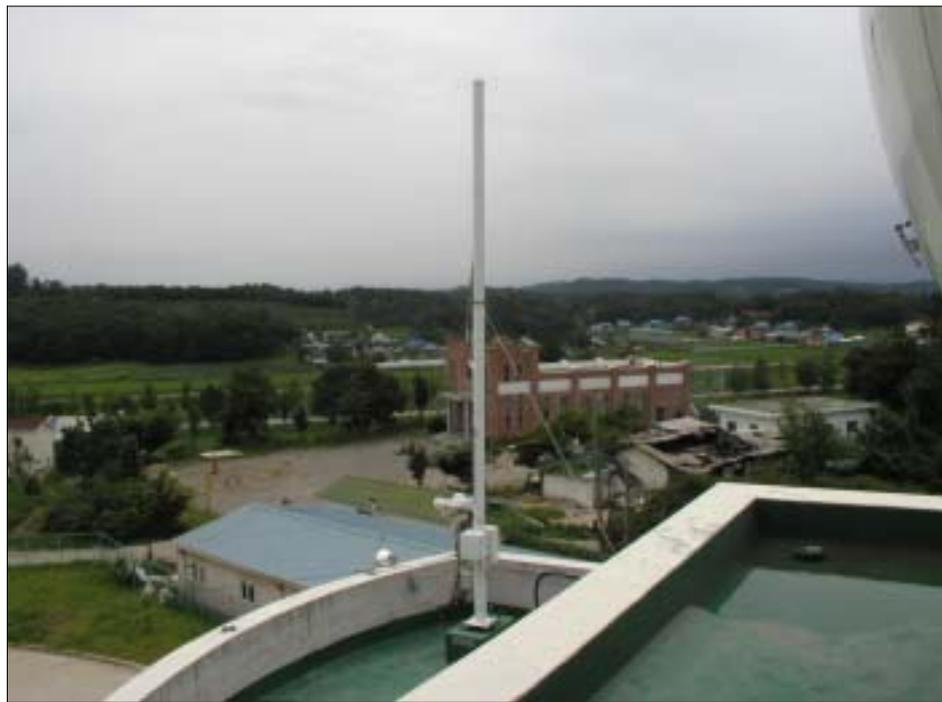
그림11. 구름방전 센서(LDAR)
