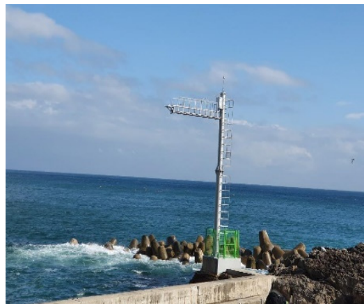
그림 3.1.1 지진해일 관측지점 위치 정보(좌) 및 임원 지진해일 파고계 사진(우)
