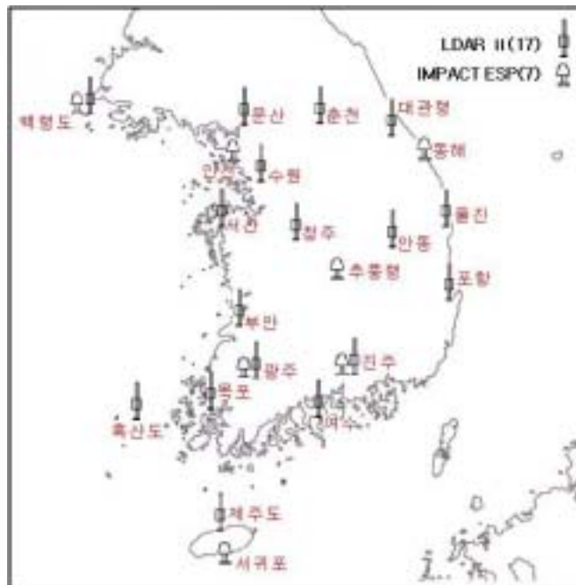
[그림 3-13] 낙뢰 및 구름방전 센서 구성도
