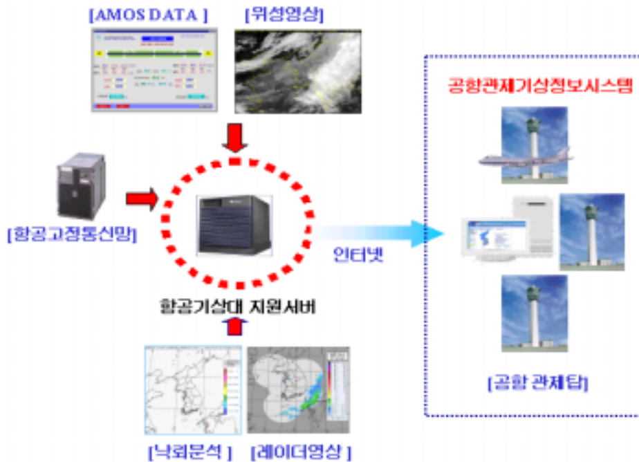
[그림 3-30] 공항관제기상정보시스템 구성도
