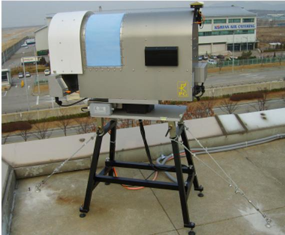
[그림 3-88] Radiometer 설치 사진
