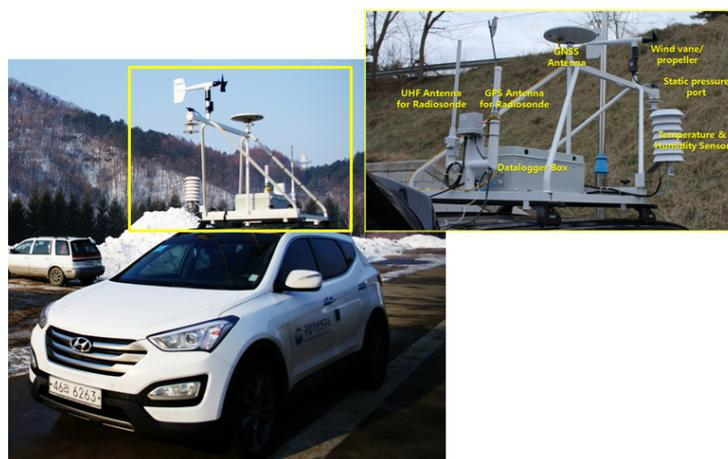
■ 그림 3-130 모바일 기상관측차량 시스템 및 관측장비 구성도
