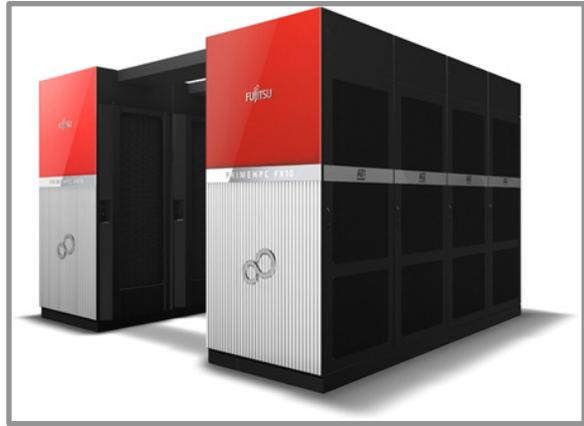
■ 그림 2-5 Fujitsu사의 FX 10시스템 랙 이미지
