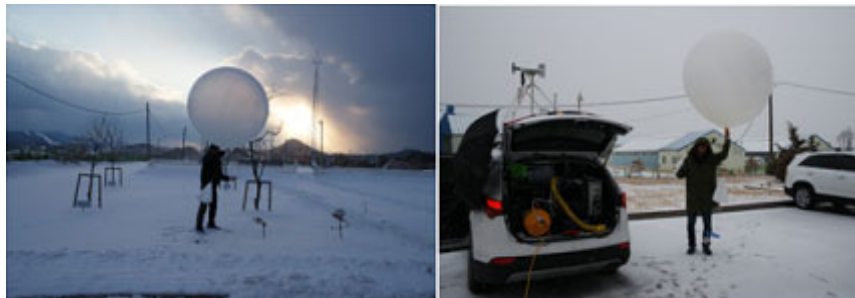
그림 3-138 모바일 기상관측차량 시스템을 이용한 고층관측 수행
