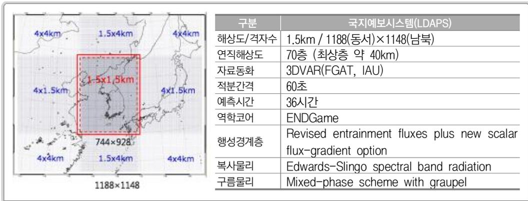
그림 3-11 국지예보시스템 모델 영역(좌) 및 모델 구성(우)
