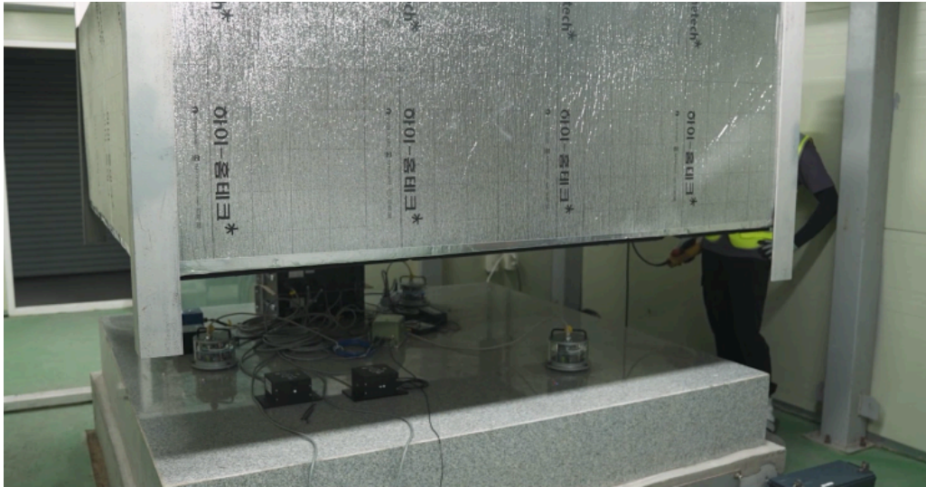
정선 다목적 지하심부 암반실험실 지진관측장비 설치 현황, 출처 = 직접 촬영
