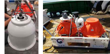
이동식 해저지진계 사진 왼쪽: 지진계 센서 오른쪽: 기록계, 배터리 등 지진계 부속장치
