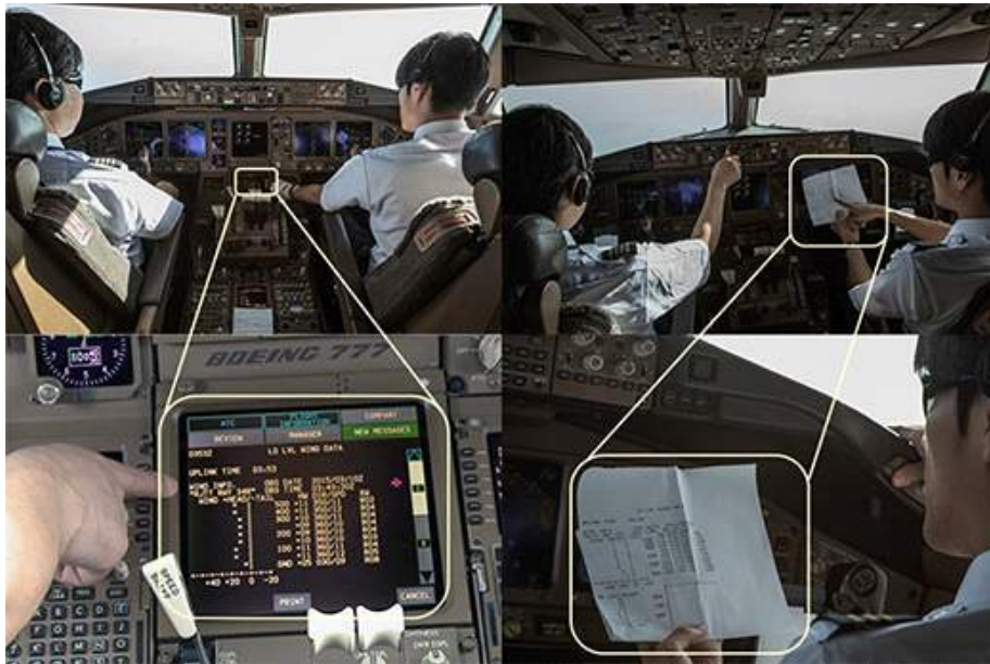
< 조종석의 조종사가 ALWIN을 사용하여 접근 경로에서 바람 정보를 확인 예시(사진 제공 : 일본 항공) >
