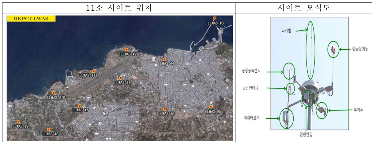
<그림> 제주공항 'LLWAS'사이트 현황 및 사이트 모식도
