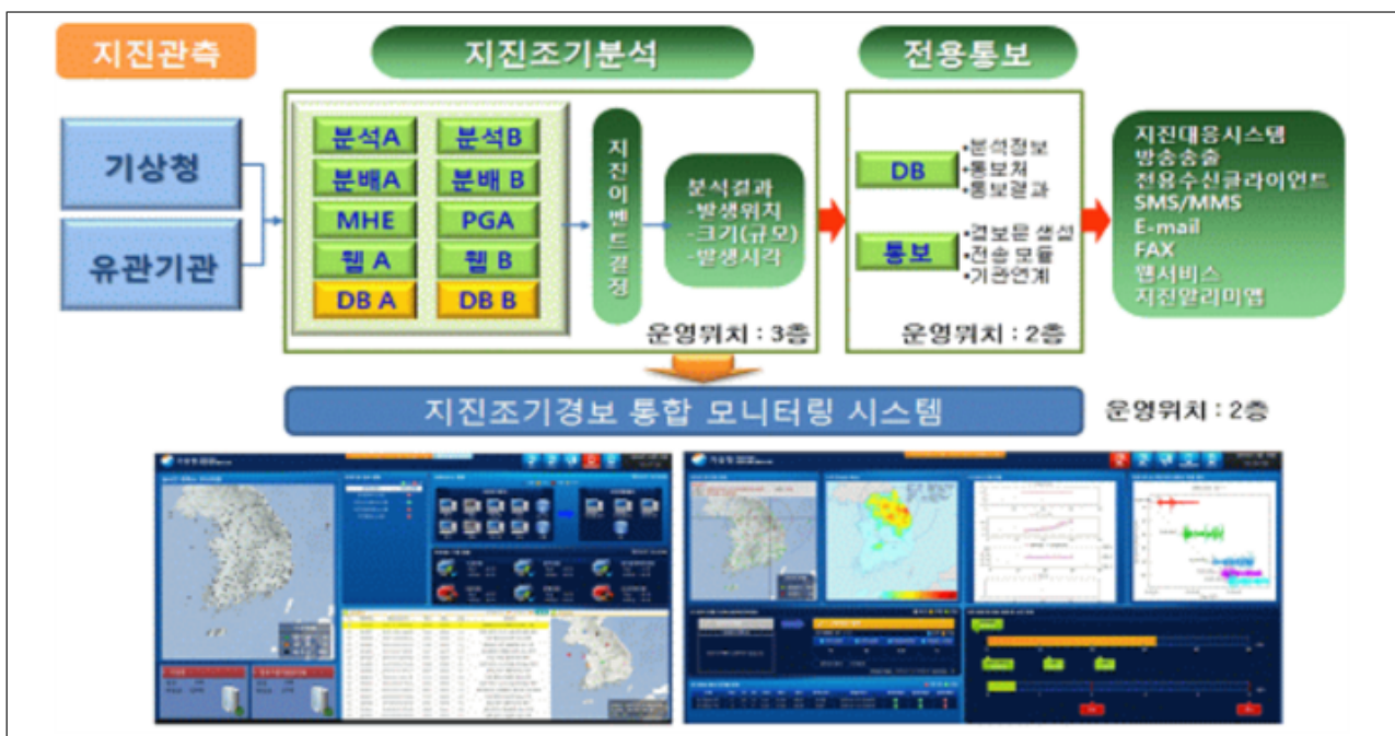
[그림 18] 지진조기경보시스템(기상청) 구성도
