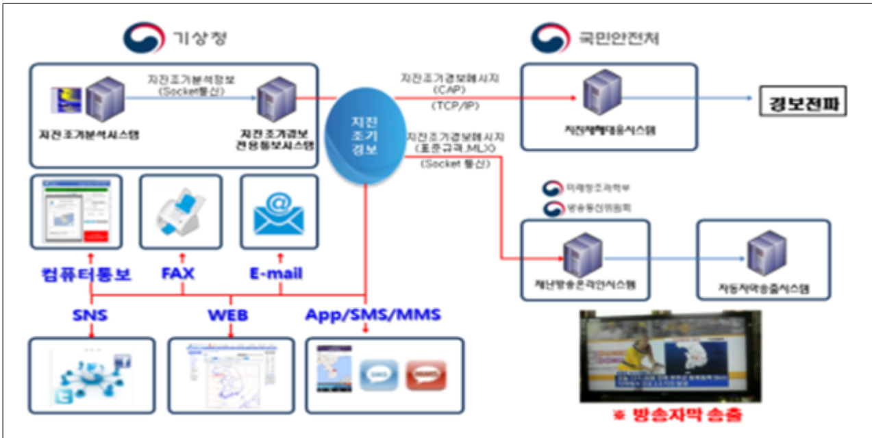
[그림 5] 지진조기경보시스템 구성도
