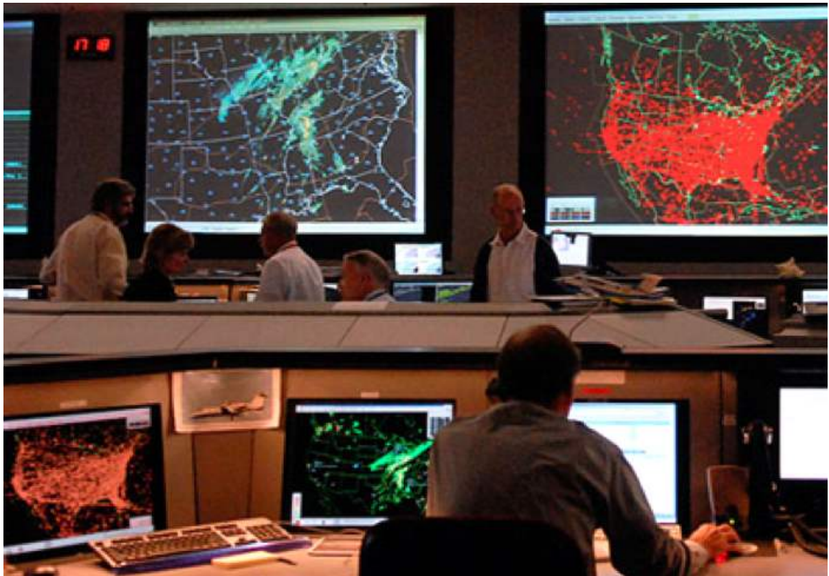
[그림 2] 미국 FAA 산하 항공운항통제센터에서 현업으로 운용되고 있는 항공기상 예보 및 정보 자료(사진의 좌측 스크린)와 항공 교통량 모니터링(사진의 우측 스크린)[출처: www.faa.gov (Official website of FAA)].
