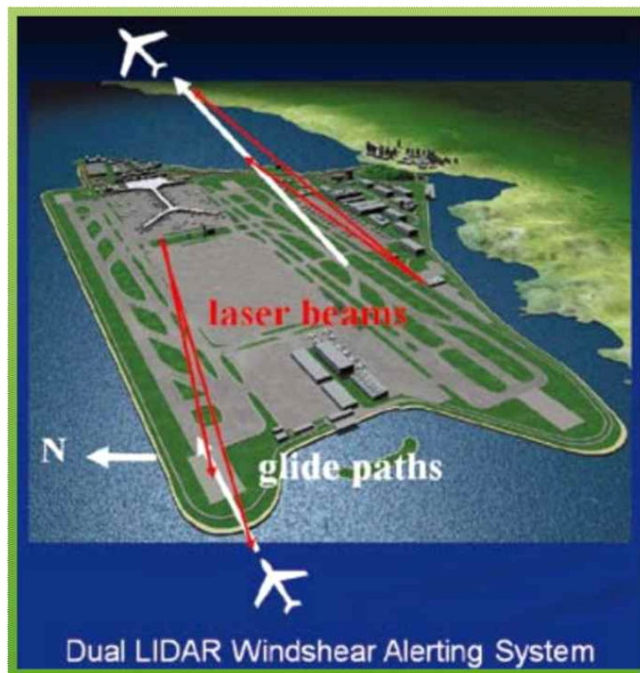
[그림 9] LIDAR 자료를 이용한 윈드시어 경보 시스템
