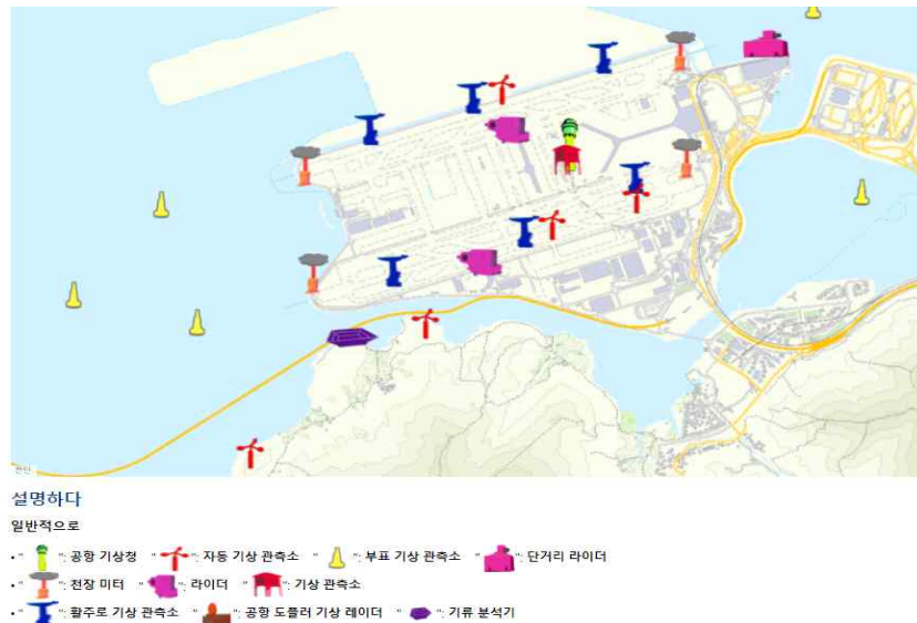
[그림 28] 홍콩공항 기상관측장비 설치현황
