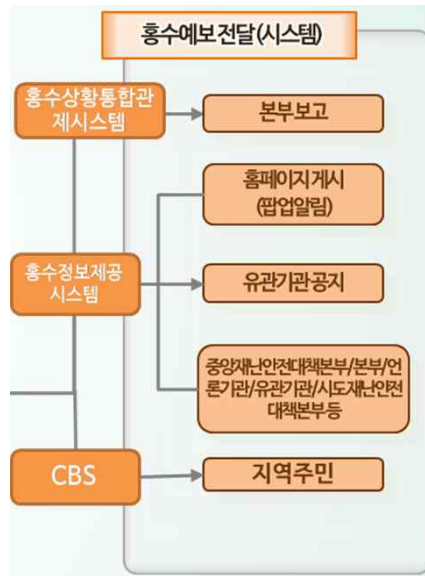
그림 2.2.4.6 홍수통제소 홍수예보 전달 시스템
