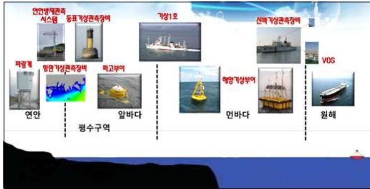
[그림 2-17] 해역별 해양기상관측장비 모식도
