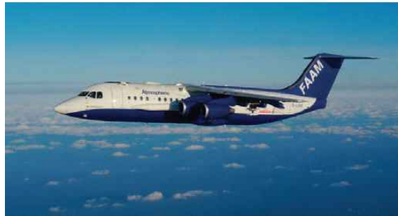
[그림 2-29] 빙정핵을 계산하는 항공기 탑재 대기관측 장비*
