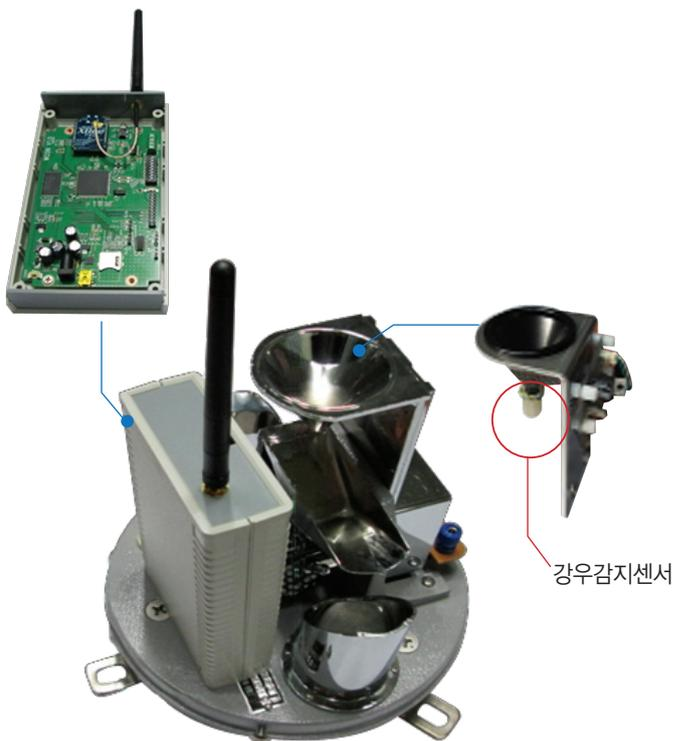
우량 센서에 IP를 부여하여 관측자료를 무선 (Wireless)통신으로 전송하는 장비. 폭우 시 동반되는 낙뢰로 인한 유선통신 장애를 개선.
