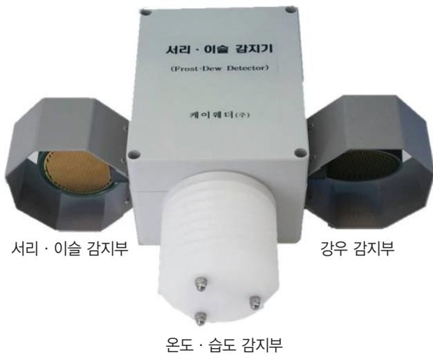
서리·이슬 감지부, 온도·습도 감지부, 강우 감지부로 구성되어 있음. 서리·이슬 감지부와 온도·습도 감지부는 대기 중의 온도와 습도를 감안하여 서리 또는 이슬 판별. 강우 감지부는 두 전극 사이의 임피던스 변화를 측정하여 감지 표면의 상태(건조, 젖음) 구별.
