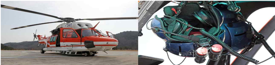
<그림 7> 야간 화재 진압 헬기 '수리온'에 내장된 야간투시경 헬멧
