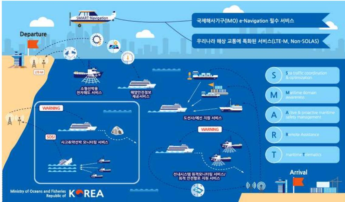
위 연구사업에서는 연안에서 100Km 범위내에서의 초고속 해상무선통신망(LTE-M)을 구축하고 이를 이용한 전자해도 실시간 스트리밍, 실시간 맞춤형 해양안전정보 서비스를 2021년 제공할 예정이다.
