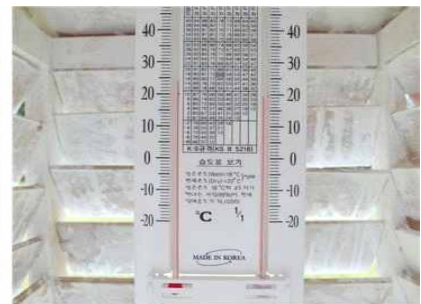
<그림 6> 백엽상 설치
